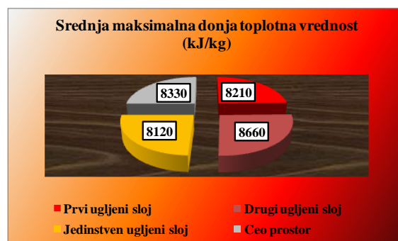
Slika 20. Uporedni prikaz maksimalne donje toplotne vrednosti ( Q_{dv}=kJ/kg ) po ugljenim slojevima i na čitavom istražnom prostoru
