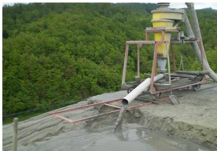
Slika 3. Hidrociklon na kruni flotacijske brane Rudnika Rudnik
