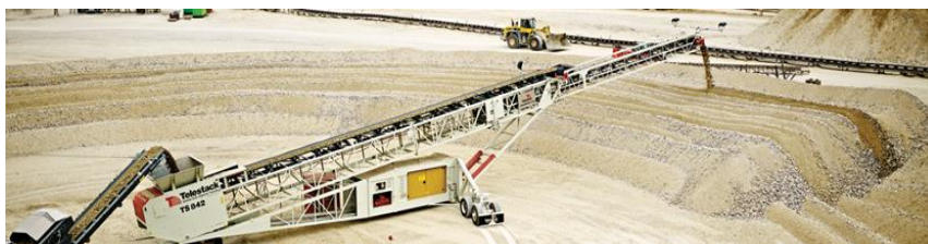
Slika 5. Teleskopska transportna traka [1]
