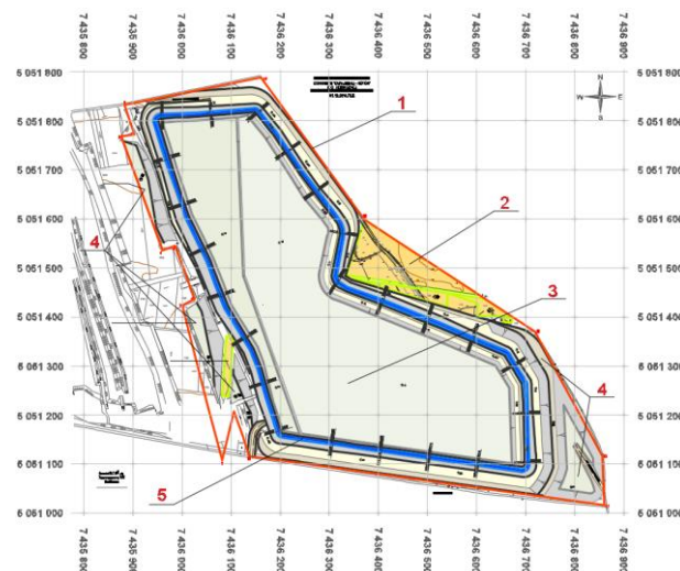
1 – Eksploataciona granica; 2 – Parcele koje nisu u vlasništvu Kompanije; 3 – Unutrašnje odlagalište, 4 – Spoljašnje odlagalište; 5 – Drenažni kanal Slika 5. Stanje radova na kraju eksploatacionog zahvata [2]
