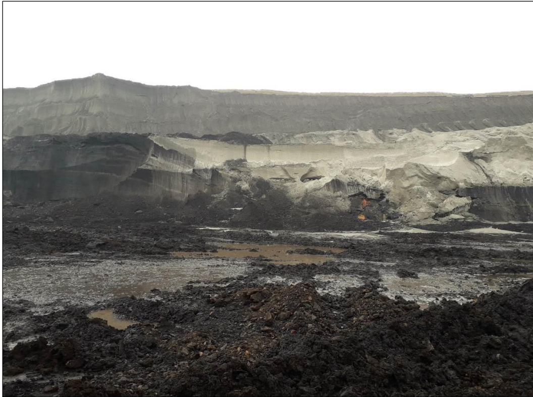
Slika 10. Kontakt gornjepontskih kvarcnih peskova i povlate jedinstvenog ugljenog sloja (granica zapadnog i istočnog dela ležišta - 1. zona nestabilnosti)
