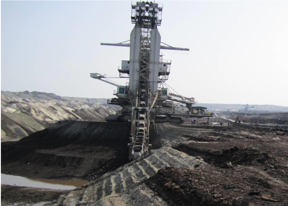
Slika 10. Drugi ugljeni sloj i bager vedričar u radu
